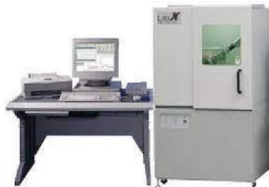
Figura 28 Foto de um difratograma de raios Shimadzu 6100.
