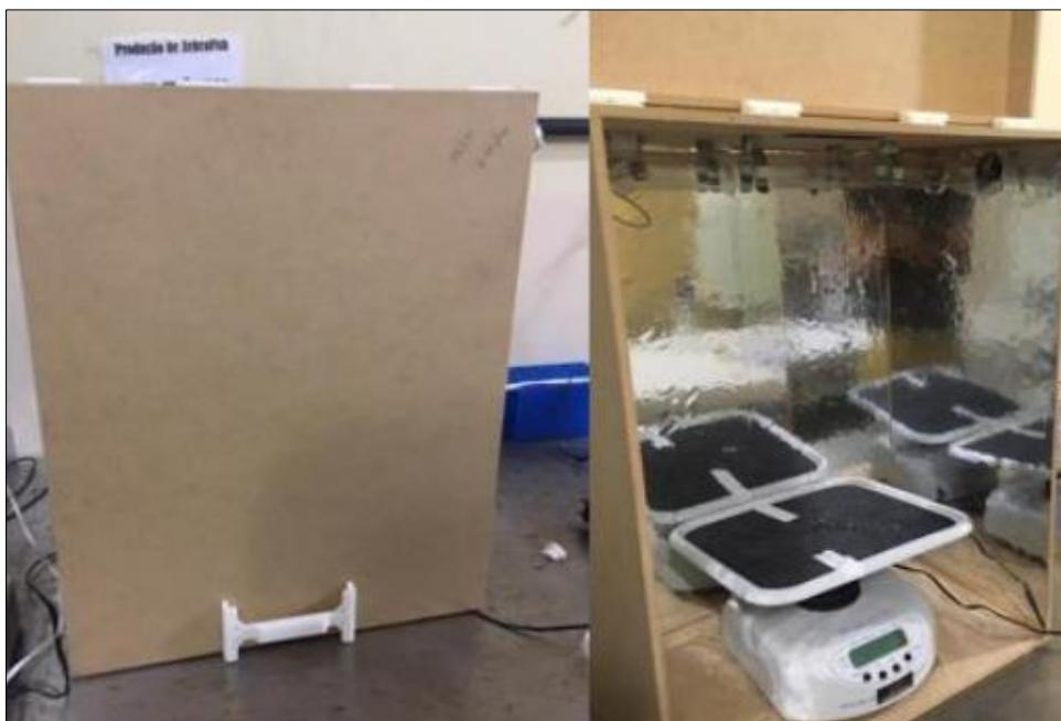
**Figura 1:** Foto da câmara de irradiação montada para a execução do projeto em questão. O modelo feito conta com agitador, duas lâmpadas UV-C de 15 Watts cada, além de alumínio ao redor de todas as laterais internas. (Autoria própria, 2019)
