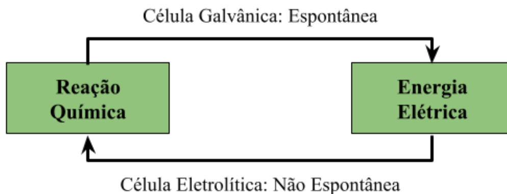
FIGURA 1.17 Células eletroquímicas usadas para a interconversão de energias química e elétrica. Fonte: Próprio autor.
