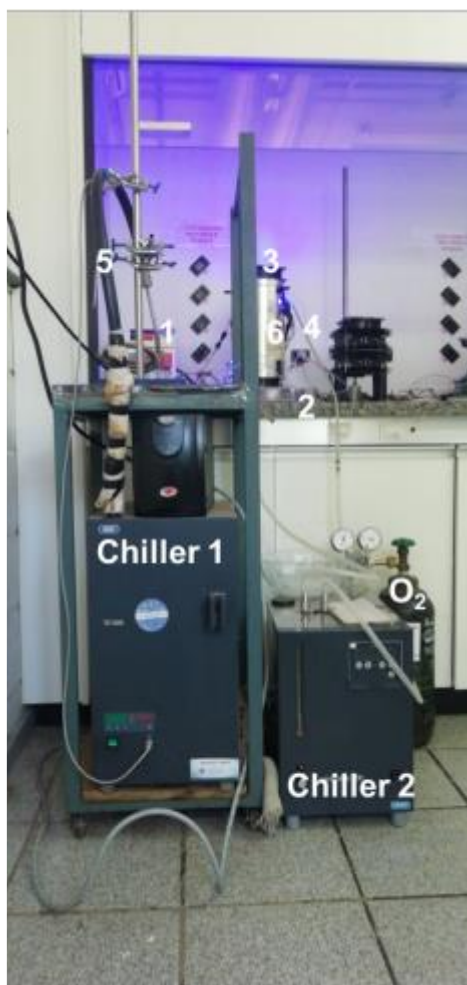
FIGURA 20. Chiller acoplado a um fotorreator.
