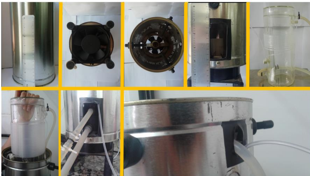
FIGURA 19. Fotorreator com sistema de tubulação secundária para resfriamento. Fonte: (AGUILLÓN et al. 2020) 17
