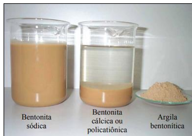
Figura 2.4: Diferenças no comportamento de dispersão de bentonitas de diferentes tipos em meio aquoso [7].
