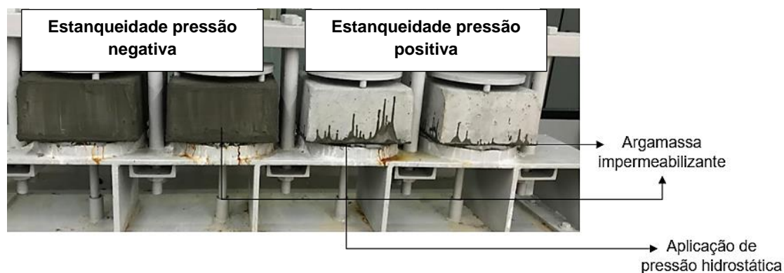
Figura 3.1: Ensaio de estanqueidade sob pressão positiva e negativa.
