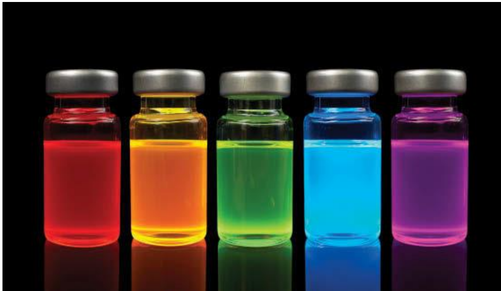
Figura 1 - Mudança de cor conforme o raio de pontos quânticos de CdSe
