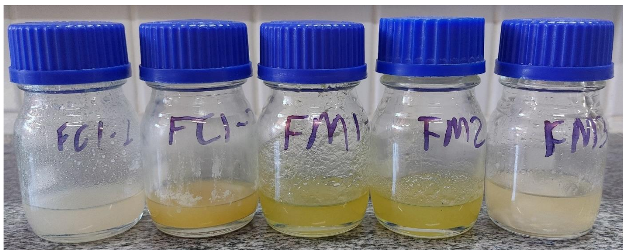
Figura 10 - Suspensões resultantes da síntese de amostras dopadas com ferro(III)
