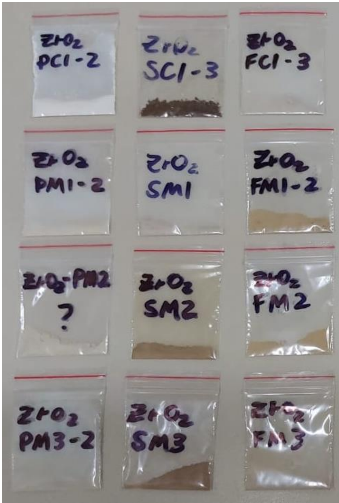
Figura 12 - Pós obtidos pela reação solvotérmica após secagem
