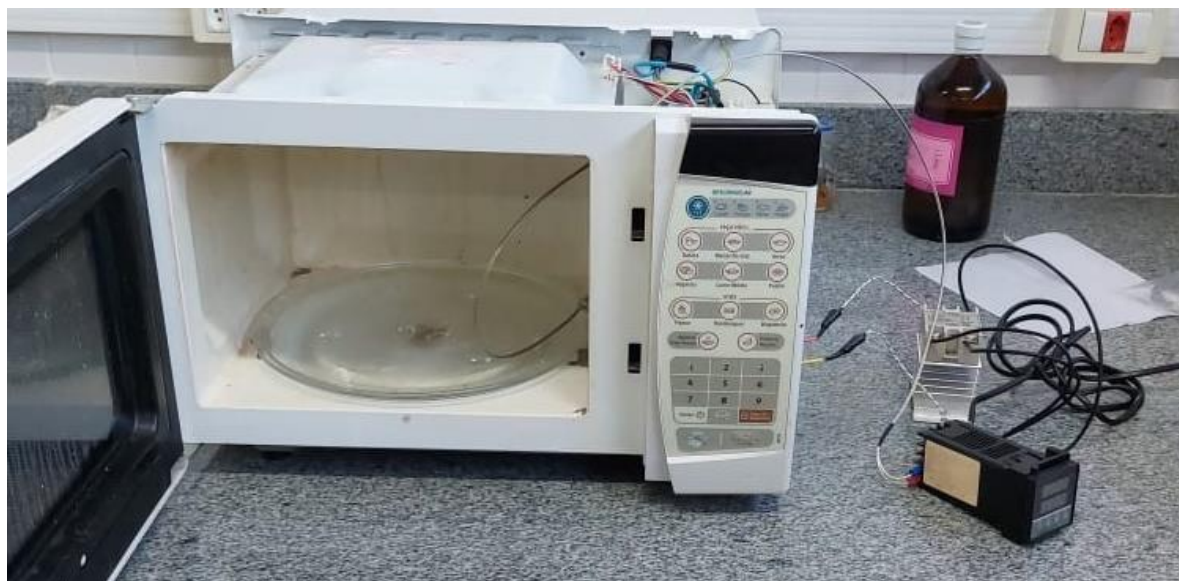
Figura 9 - Aparato reacional com forno de micro-ondas
