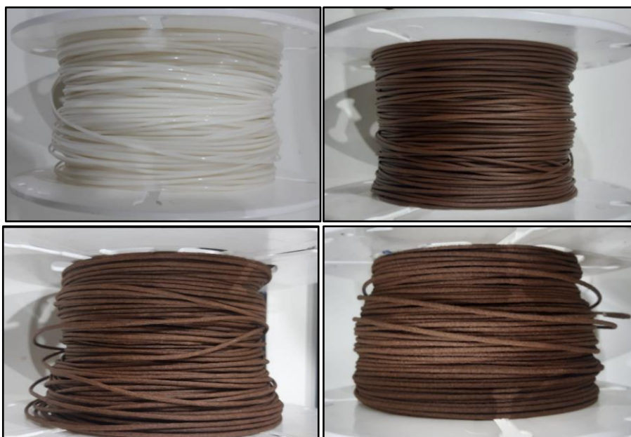
Figura 6.7 – Imagens dos filamentos produzidos: (a) PBS Puro, (b) PBS +10% PCAC, (c) PBS + 20% PCAC e (d) PBS + 30% PCAC..
