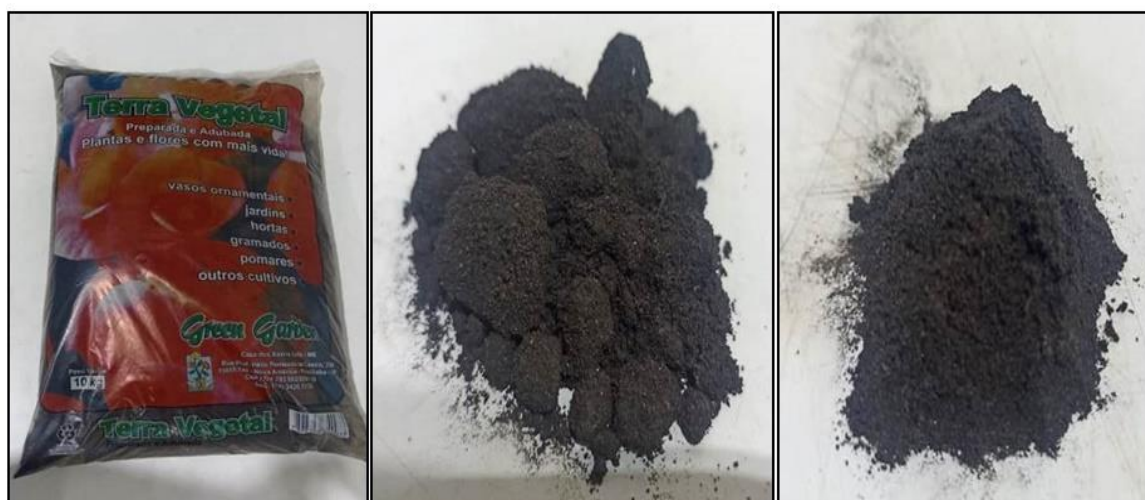
Figura 5.9 – Composto utilizado para realização do teste de desintegração: (a) embalagem do composto, (b) composto como recebido e (c) composto após processo de peneiramento.
