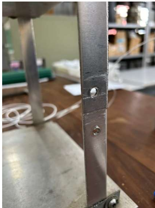
Figura 10 – Viga sem junta parafusada.
