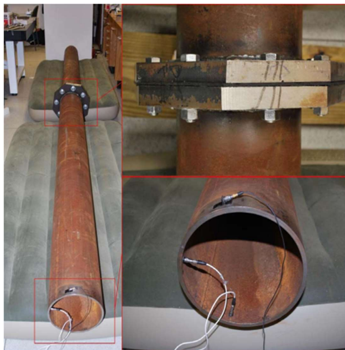
Figura 2 – Gasoduto com flange parafusada instrumentado com acelerômetros.
