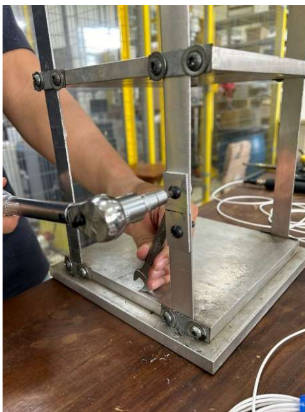
Figura 9 – Procedimento de aperto dos parafusos.
