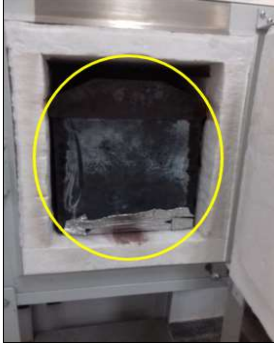
Figura 4 - Caixa de aço adaptada ao forno mufla.
