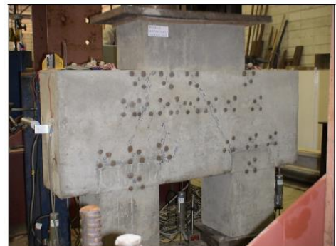
Figura 37 – Bloco sobre duas estacas ensaiado por Delalibera (2006)
