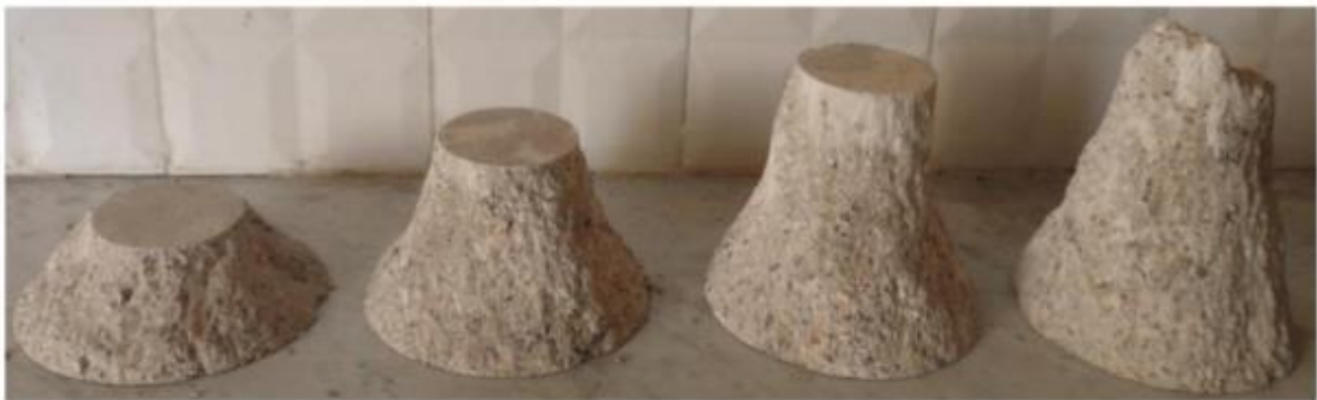
Figura 22 – Inclinação da superfície de falha para amostras com altura de 5 cm, 10 cm, 15 cm e 20 cm, respectivamente, da esquerda para direita.
