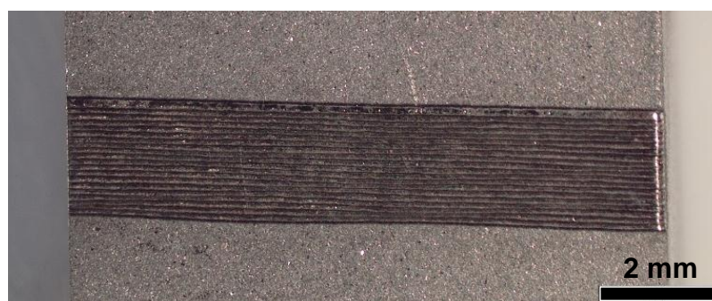
Figura 3.6 - Exemplo de trilha sobreposta formada no substrato de uma das ligas Al-Mg-Sc após o tratamento de RSL.
