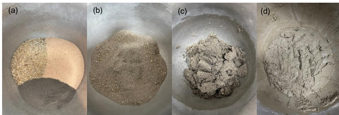
Figura 14 - Procedimento de mistura: (a) Adição dos Agregados; (b) Mistura seca dos agregados; (c) Mistura úmida dos agregados; e (d) Argamassa final com cimento
