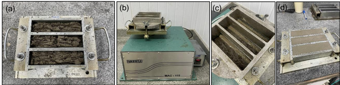
Figura 29 - Moldagem de corpos de prova para ensaios mecânicos: (a) molde com argamassa antes do adensamento; (b) equipamento para adensamento; (c) molde com argamassa após adensamento; e (d) corpos de prova após rasamento
