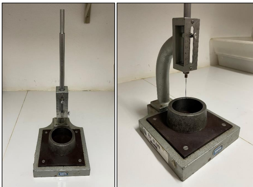
Figura 16 - Aparato experimental para medição dos tempos de pega por agulha de Vicat
