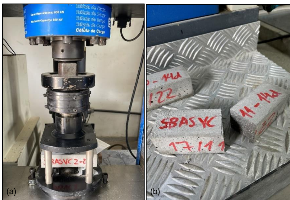
Figura 31 - Ensaio de resistência à tração na flexão: (a) ensaio em andamento; e (b) CP após rompimento
