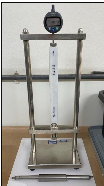
Figura 26 - Aferição da variação dimensional por aparelho comparador
