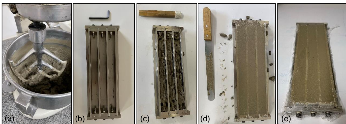
Figura 24 - Etapas de moldagem dos corpos de prova prismáticos para ensaio de retração autógena até a cura inicial (a) Mistura; (b) Fixação dos pinos após aplicação de óleo; (c) aplicação da argamassa em duas camadas; (d) regularização da superfície; e (e) armazenamento em câmara seca
