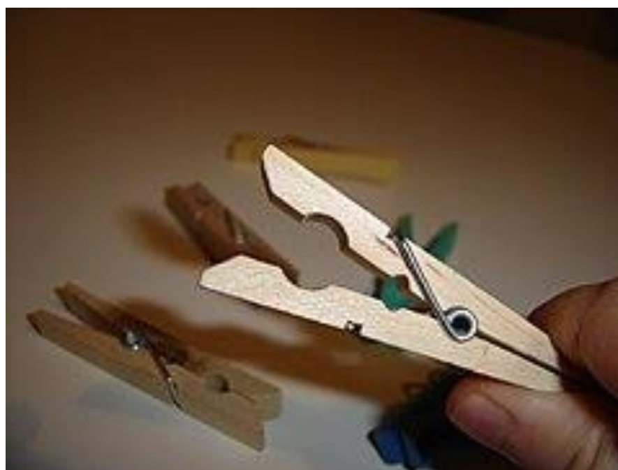
Figura 3.26 – Mola de torção em prendedor de roupa.
