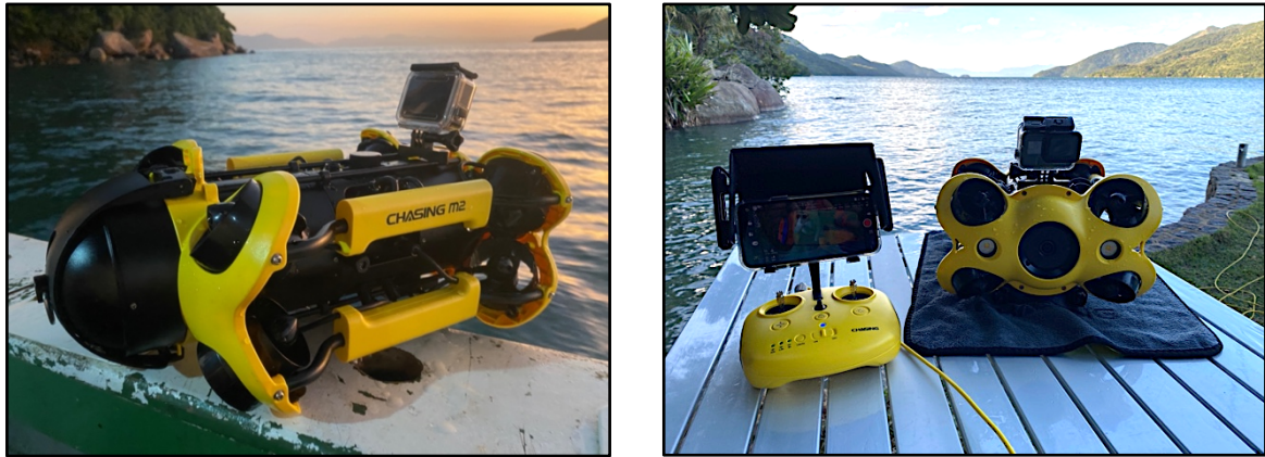
Figura 2. ROV ( Remotely Operated Vehicle ) utilizado no censo visual da ictiofauna. Fonte: autor.
