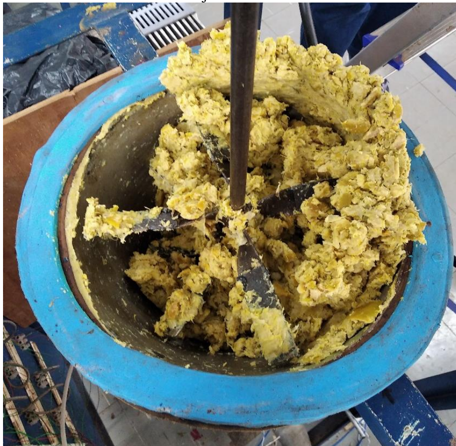
Figura 1.19. Formação de aglomerado de bagaço de laranja in natura na região cilíndrica do leito do jorro modificado.
