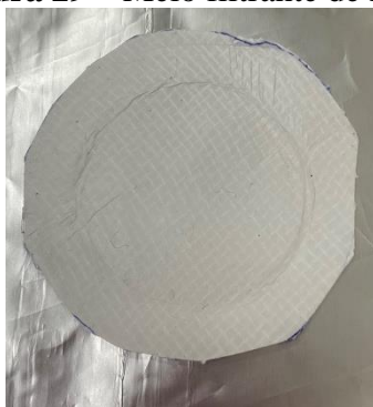
Figura 29 – Meio filtrante de PET.
