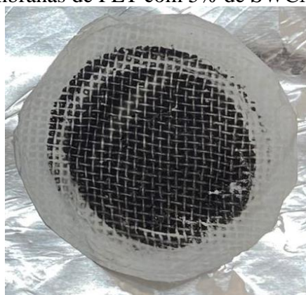
Figura 39 – Membranas de PET com 5% de SWCNTs em superfície.
