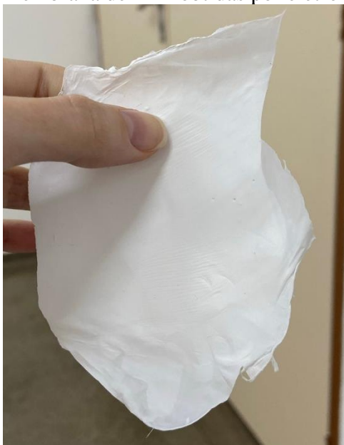
Figura 18 – Membrana de PET obtidas por eletrofiação.
