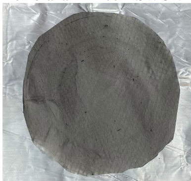
Figura 34 – Membrana PET com SWCNTs em solução.
