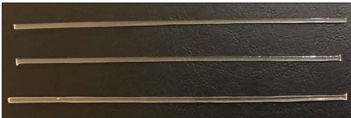
Figura 20. PLA 100: exemplificação dos filetes impressos como amostra
