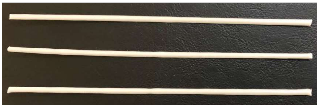
Figura 36. Blenda PLA/PCL 80/20: Exemplificação dos filetes impressos como amostra do material
