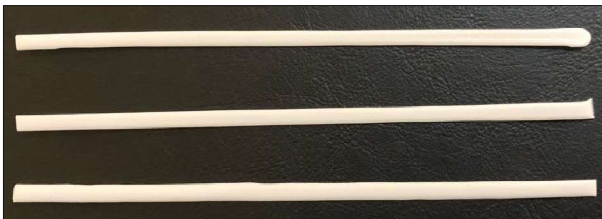
Figura 26. Exemplificação dos filetes impressos como amostra do PCL 100
