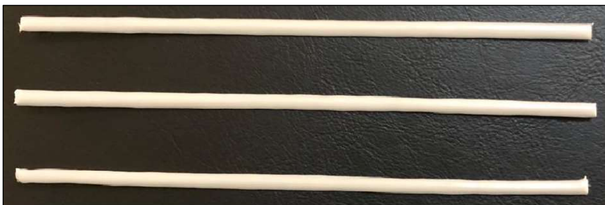
Figura 41. Blenda PLA/PCL 70/30: exemplificação dos filetes impressos como amostra
