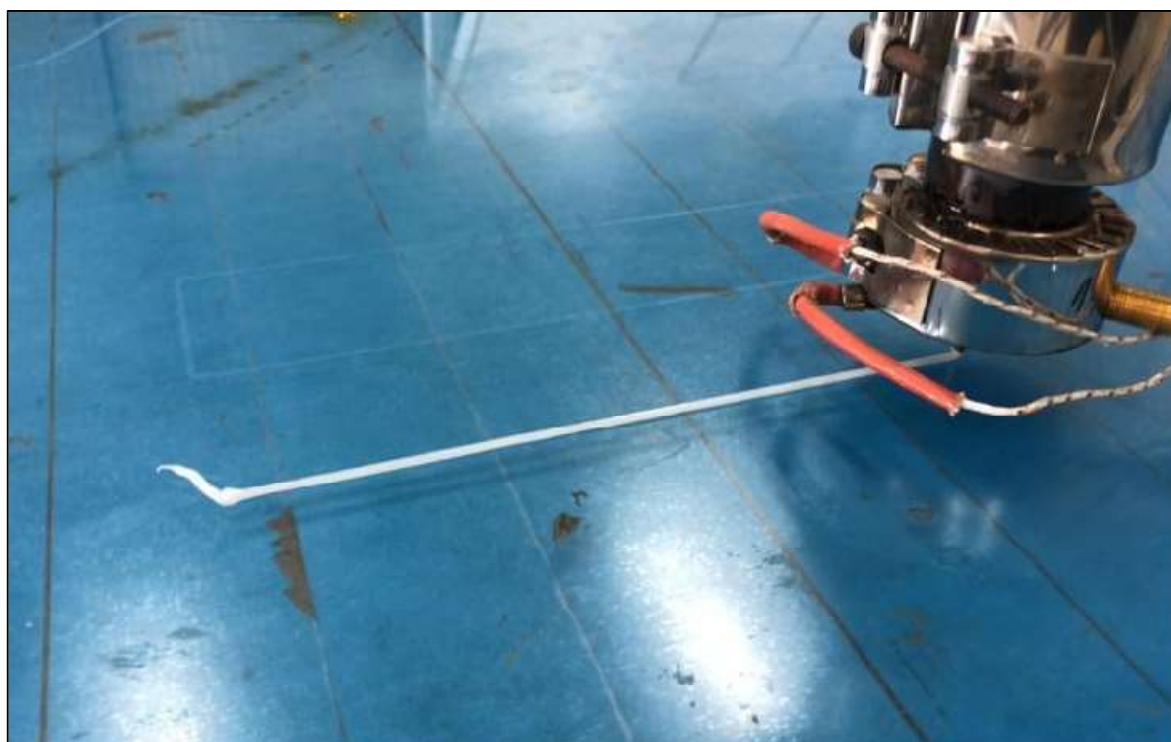
Figura 19. Exemplificação do processo de impressão de filetes
