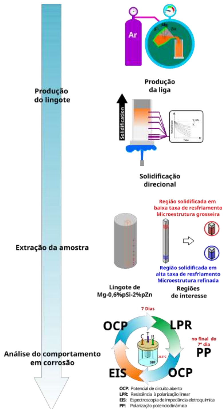
Figura 3-12 - Procedimento utilizado na avaliação do comportamento em corrosão da liga Mg-0,6%Si-2%Zn.
