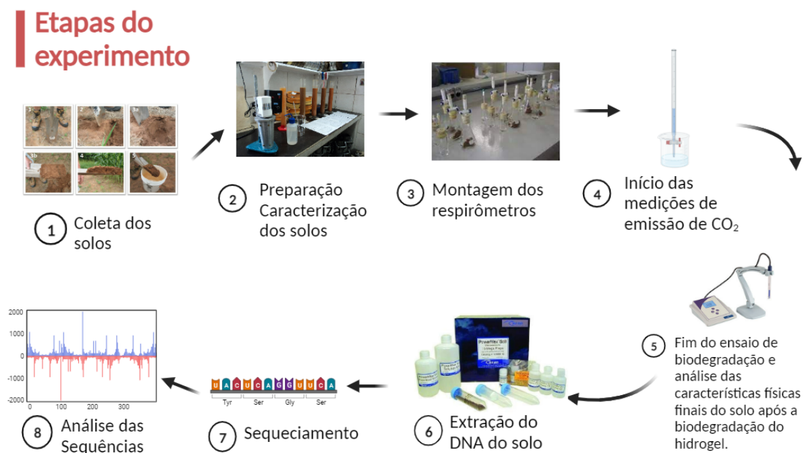
Figura 3 - Esquema das etapas de desenvolvimento do ensaio de biodegradação, envolvendo o hidrogel sintetizado a partir de amido com dianidrido do ácido etilendiaminotetracético, por meio de respirometria de Bartha. Elaborado pela autora com BioRender®.
