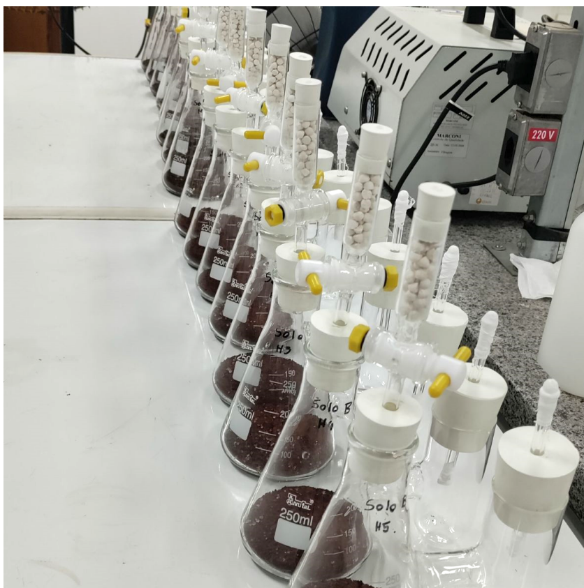
Figura 9 – Respirômetros preparados para a incubação com solo, com e sem (controle) amostras de hidrogel, e solução de KOH no braço lateral para a captação de CO 2 . Fonte: Autoria própria
