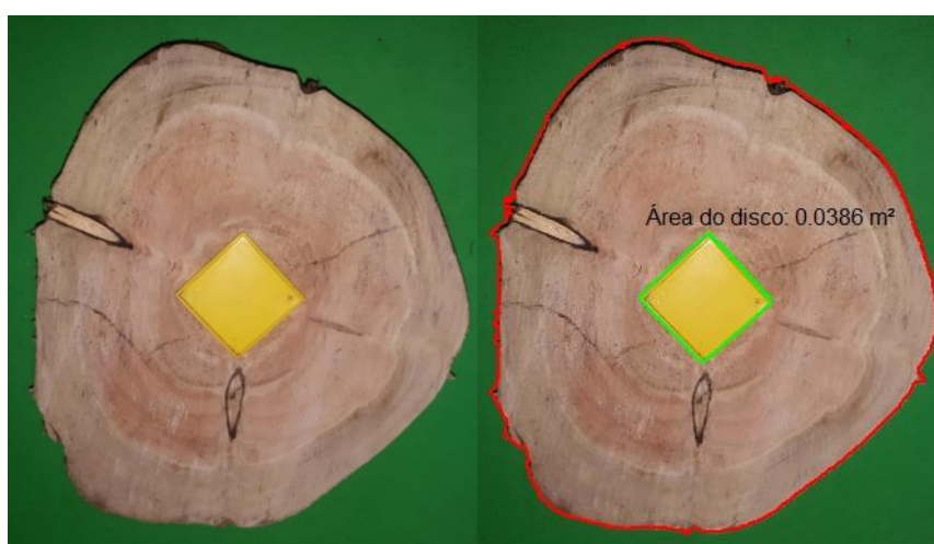
FIGURA 2. Disco de madeira retirado na altura de medição antes e depois do processamento pela Rede Neural Artificial.
