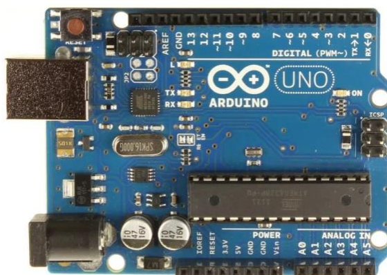
Figura 4: Arduino UNO, interface compacta com entradas analógicas, digitais e portas de comunicação, incluindo USB, alimentação e programação. Fonte: Eletrodex
