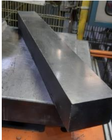
Figura 4.7: Imagem de um dos tijolos MgO-C obtidos após o processo de prensagem. (foto: arquivo pessoal).
