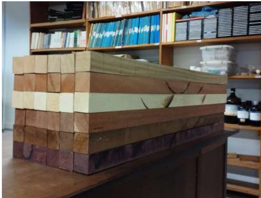
Figura 17 - Corpos de Prova utilizados na pesquisa, de cima para baixo, tem-se: Pequiá, Cupiúba, Marupá, Sapucaia, Tatajuba e Roxinho.
