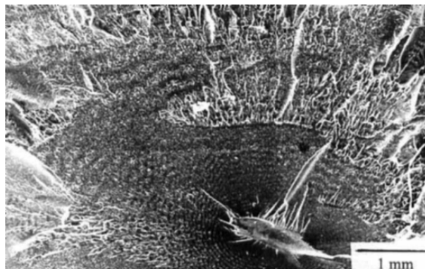
Figura 18 - Superfície de fratura por tração de floco reciclado, mostrando fratura frágil iniciada a partir de uma partícula de impureza [31].
