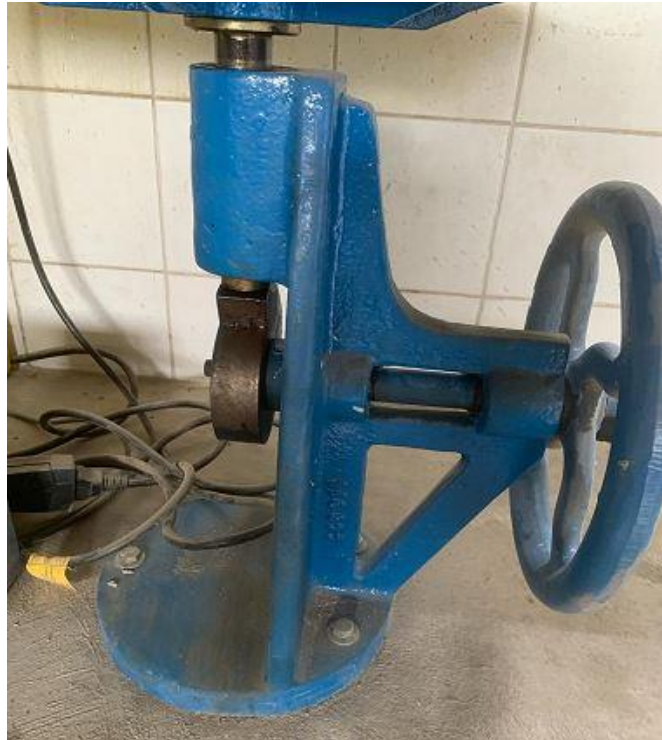
Figura 27 - Entalhe no sistema da mesa de adensamento para geração do impacto
