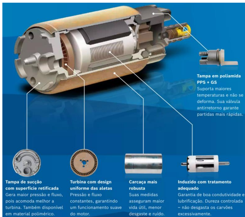
Figura 2 - Esquema de uma bomba de combustível padrão e seus principais componentes.
