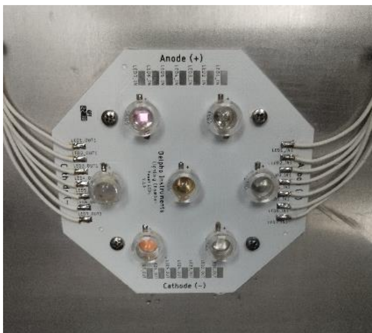
Figura 2.5. Placas LED instaladas no teto da câmara de irradiação.
