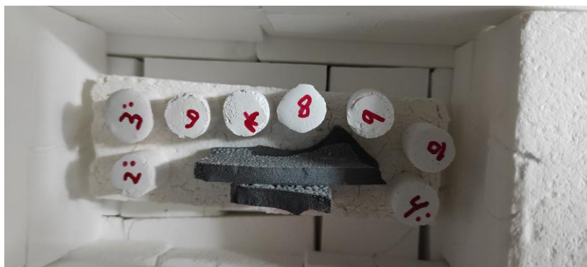
Figura 3.3 – Vista superior do interior da estrutura isolante dentro da cavidade do forno de micro-ondas. Na imagem, susceptores de carbeto de silício e amostras macroporosas podem ser observados.
