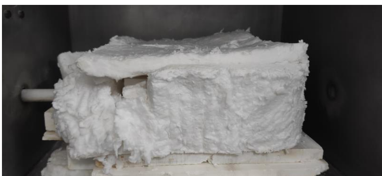
Figura 3.2 – Cavidade do forno do equipamento de micro-ondas com a estrutura isolante já montada.
