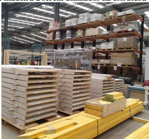
Figura 90 - Elementos de madeira a serem utilizados na estrutura dos módulos – Empresa F
