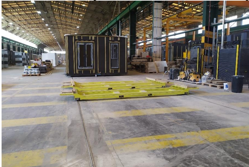
Figura 73 - Trilhos no chão e pranchas com rodízios sobre eles – Empresa C
