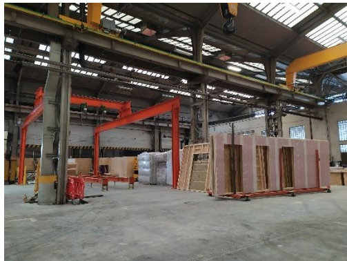
Figura 47 - Pontes rolantes no chão de fábrica – Empresa B
