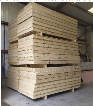
Figura 80 - Painéis de fechamento externo em estrutura de madeira empilhados – Empresa D
