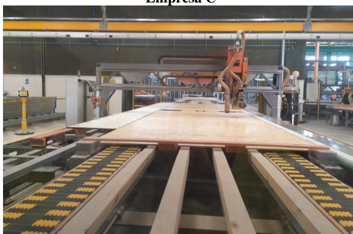
Figura 77 - Máquina CNC para realização de cortes nas chapas OBS e nas chapas de gesso – Empresa C
