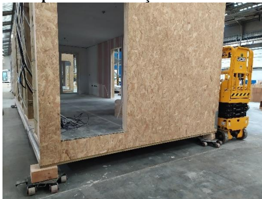
Figura 39 - Rodízios para movimentação dos módulos – Empresa B
