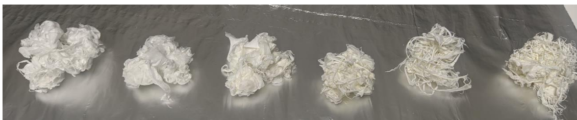
Figura 3.4 – Fibras poliméricas de poli(álcool vinílico) (PVA) e zeína. A partir da esquerda: 100 % PVA / 0 % zeína, 87,5 % PVA / 12,5 % zeína, 75 % PVA / 25 % zeína, 62,5 % PVA / 37,5 % zeína, 50 % PVA / 50 % zeína e 37,5 % PVA / 62,5 % zeína.
