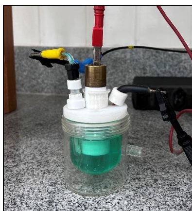
FIGURA 4.2: Célula eletroquímica tipo Methrom com três eletrodos.
