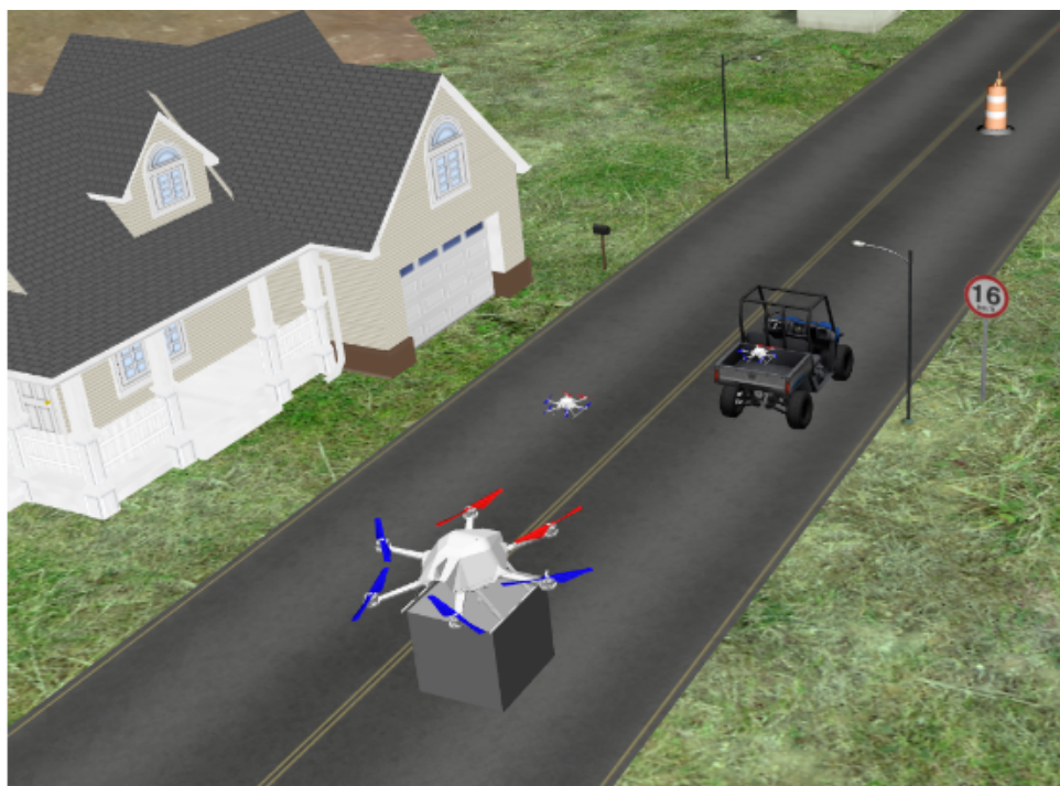
FIGURA 4.4 – Simulador RotorS com o ambiente construído a partir de modelos padrões do Gazebo e um Firefly hex-rotor helicopter. (FURRER et al., 2016)
