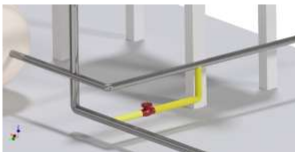
Figura 22 – Picagem para uso do gás não liquefeito
