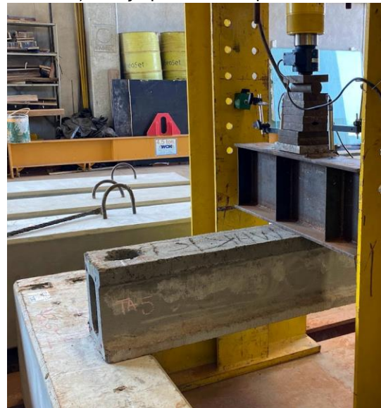
Figura 4.57: TA 05 – Lado A, posicionada para o ensaio de resistência a força cortante.
