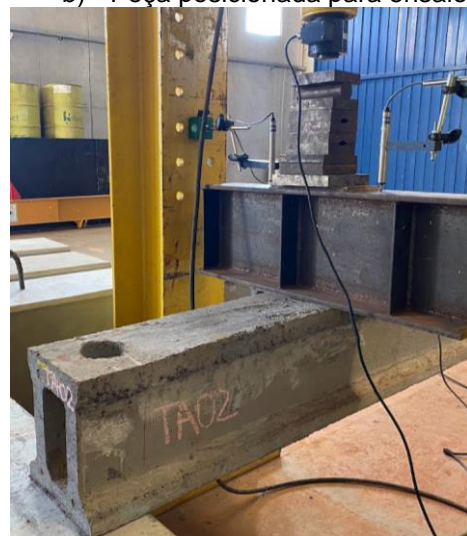
Figura 4.39: TA 02 – Lado A, posicionada para o ensaio de resistência a força cortante.
