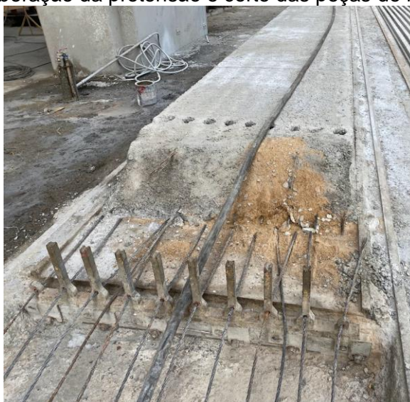
Figura 2.12: Liberação da protensão e corte das peças de lajes alveolares.
