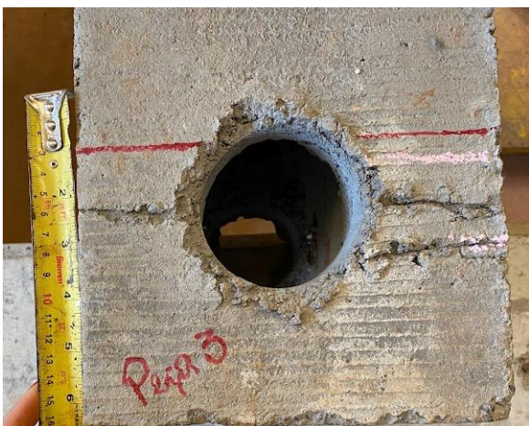
Figura 4.45: TA 03 – Lado A, posicionada para o ensaio de resistência a força cortante.
