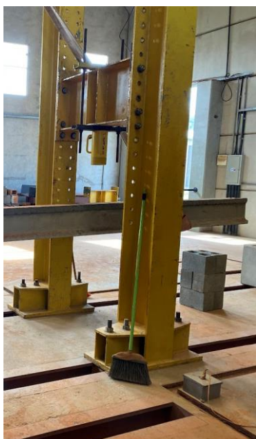
Figura 3.13: Posicionamento das peças para o ensaio de resistência à flexão.
