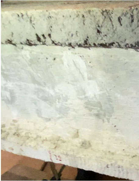
Figura 4.23: Evolução da fissuração na TA 06.
