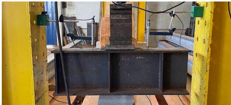
Figura 3.7: Chapas metálicas auxiliares.
