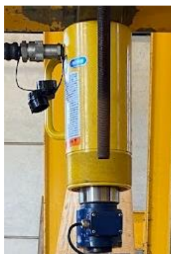
Figura 3.5: Atuador hidráulico e célula de carga.
