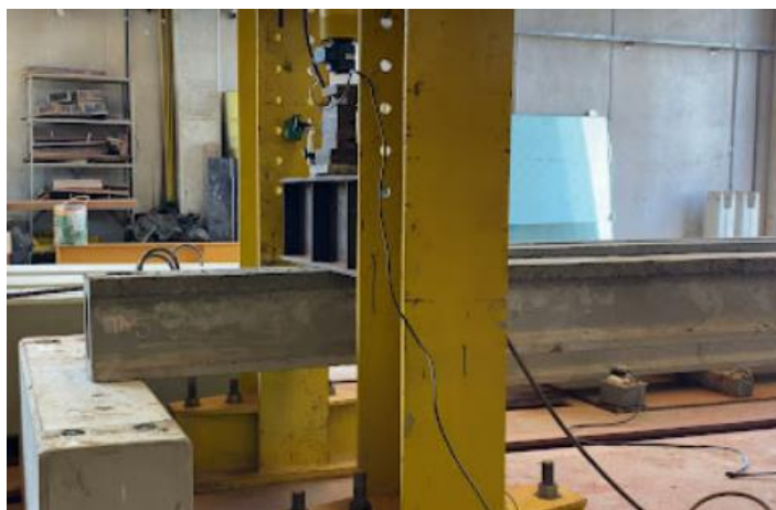
Figura 3.17: Peça posicionada para o ensaio de resistência à força cortante.
