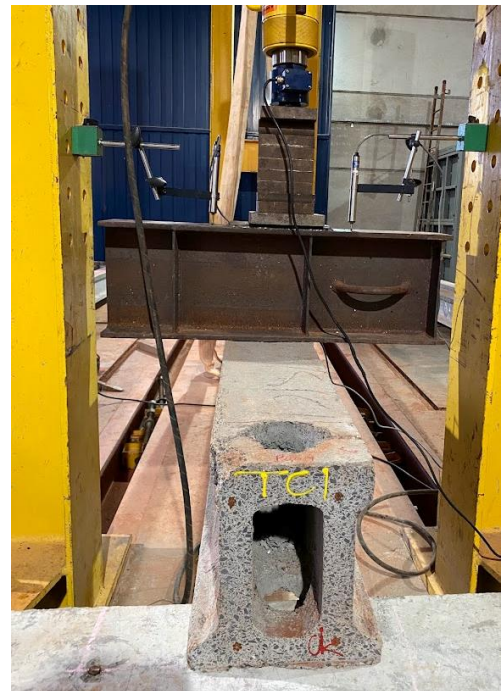
Figura 4.51: TA 04 – Lado A, posicionada para o ensaio de resistência a força cortante.
