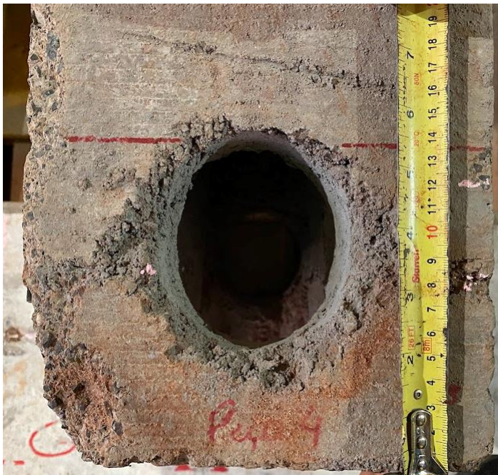
Figura 4.51: TA 04 – Lado A, posicionada para o ensaio de resistência a força cortante.
