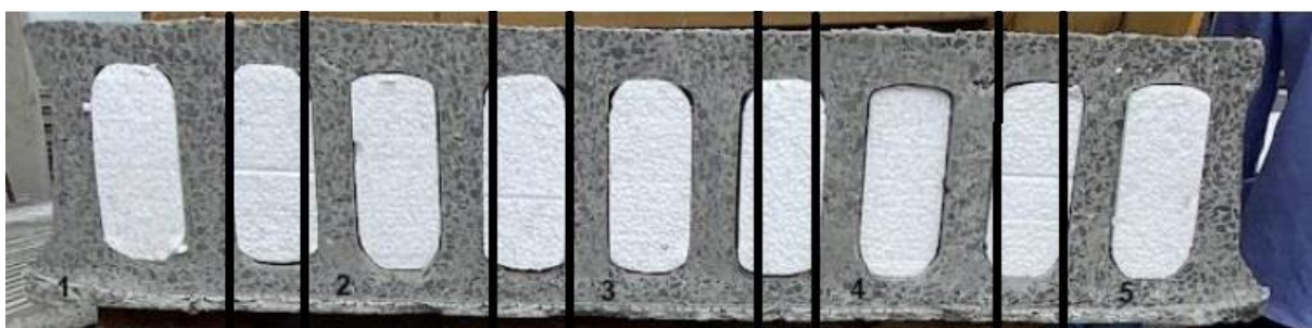
Figura 2.15: Representação de seccionamento de laje para terça alveolar.
