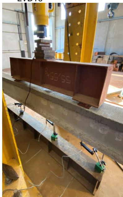
Figura 3.13: Posicionamento das peças para o ensaio de resistência à flexão.
