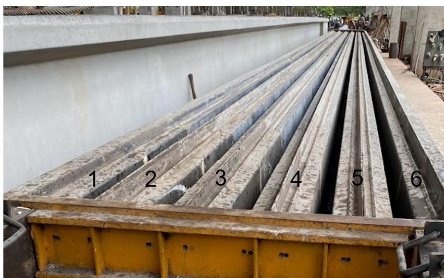
Figura 2.2: Máquina utilizada para fabricação de Terças em T.
