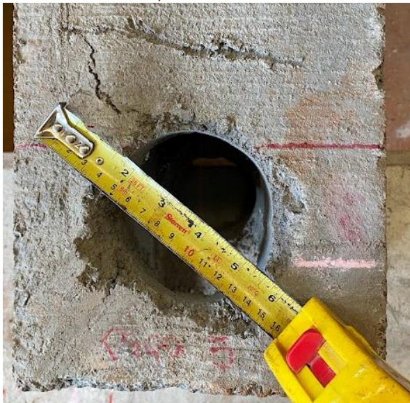
Figura 4.57: TA 05 – Lado A, posicionada para o ensaio de resistência a força cortante.
