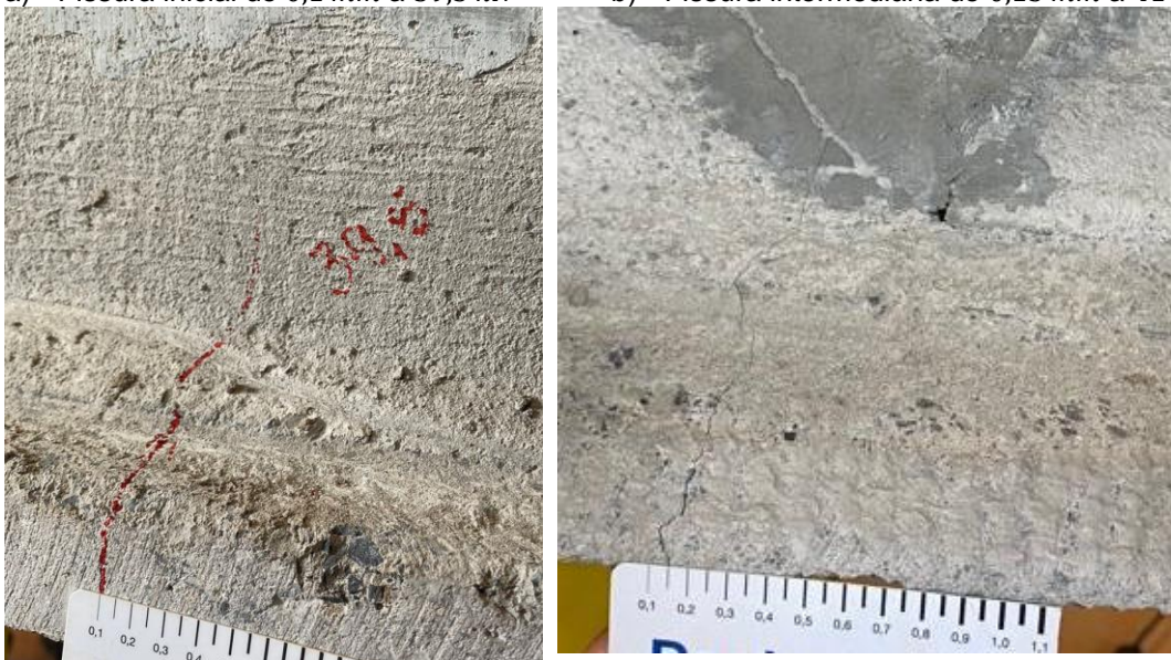
Figura 4.14: Evolução da fissuração TA 03.
