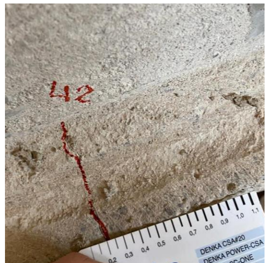
Figura 4.8: Evolução da fissuração TA 01.
