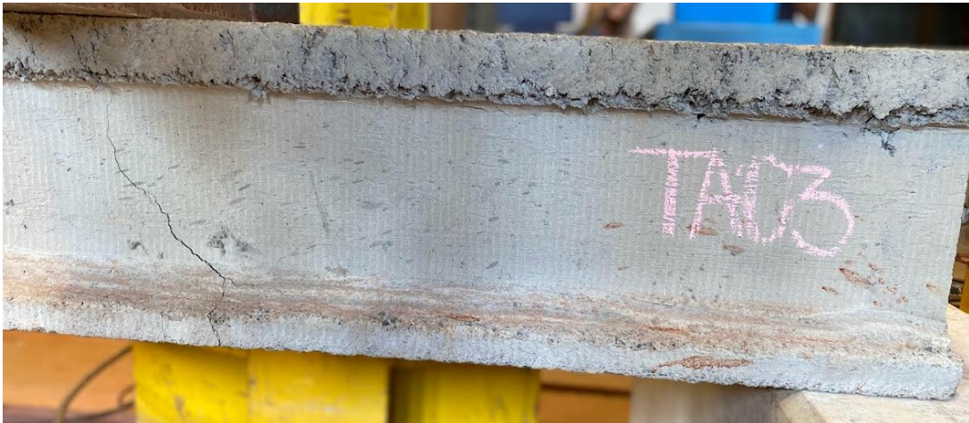
Figura 4.47: Fissura identificada na ruptura da peça TA 03 – Lado A.
