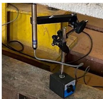
Figura 3.6: Transdutor de deslocamento variável LVDT.
