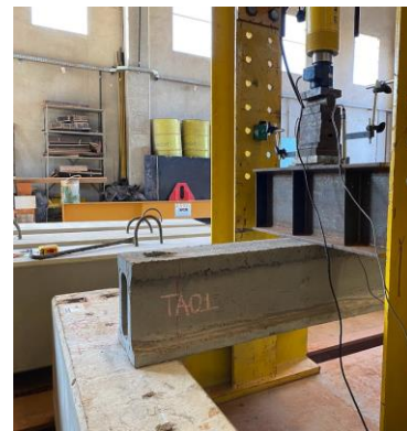
Figura 4.33: TA 01 Lado A posicionada para ensaio de resistência a força cortante.
