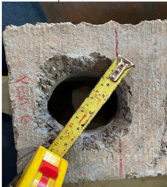
Figura 4.63: TA 06 – Lado A, posicionada para o ensaio de resistência a força cortante.
