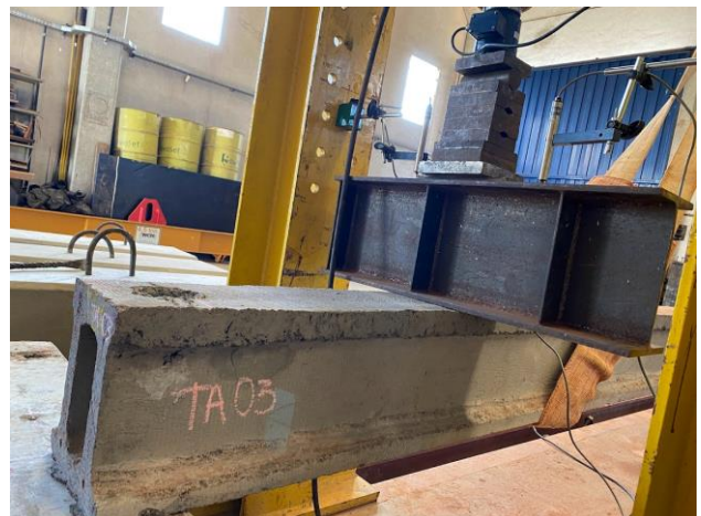
Figura 4.45: TA 03 – Lado A, posicionada para o ensaio de resistência a força cortante.
