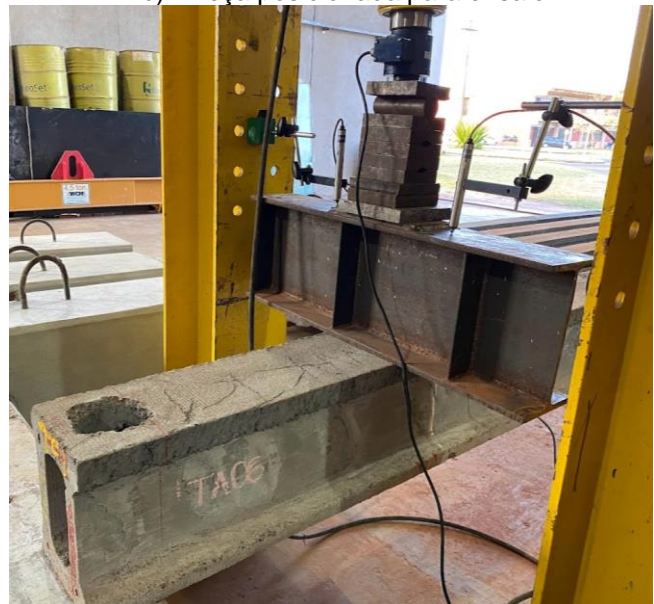
Figura 4.63: TA 06 – Lado A, posicionada para o ensaio de resistência a força cortante.
