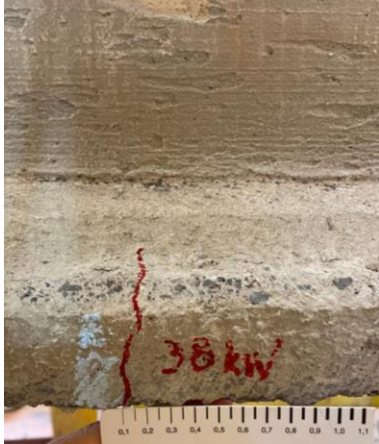
Figura 4.11: Evolução da fissuração TA 02.
