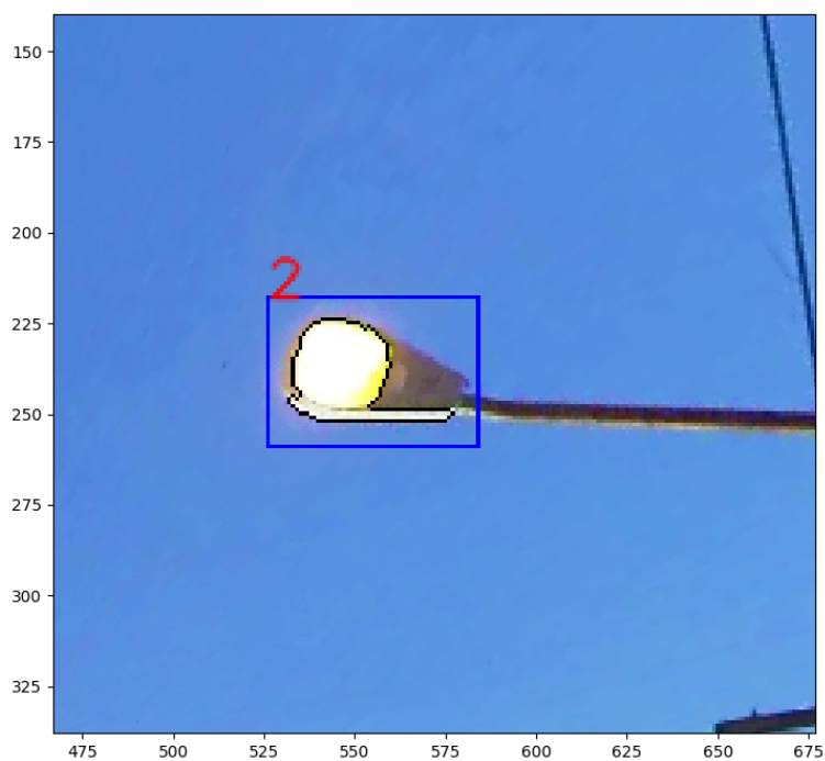
Figura 42 – Exemplo de imagem onde não houve a detecção devido ao reflexo no corpo da luminária que interferiu na definição da borda, atrapalhando o algoritmo de crescimento de região
