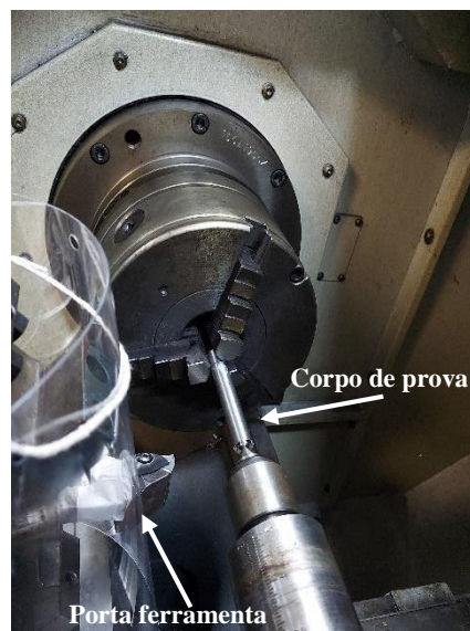
Figura 13 – Setup experimental em um torno CNC.
