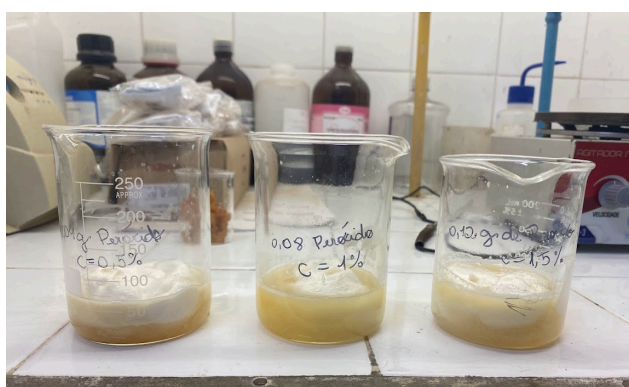
Figura 3.1 - Coágulos formados depois da adição de ácido acético.
