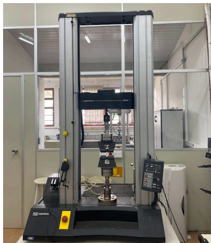
Figura 3.12 - Máquina Instron para ensaio de tração.
