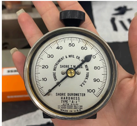
Figura 3.11 - Durômetro tipo Shore A.
