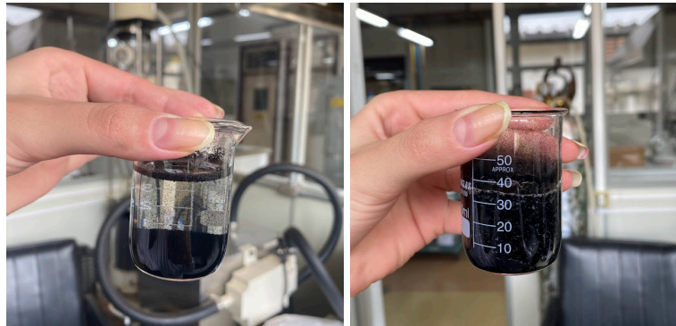
Figuras 3.2 - (a) Sistema (água + peróxido + surfactante + nanotubos de carbono) após mistura no agitador magnético. (b) “Gel” formado pelo sistema após sonicação.
