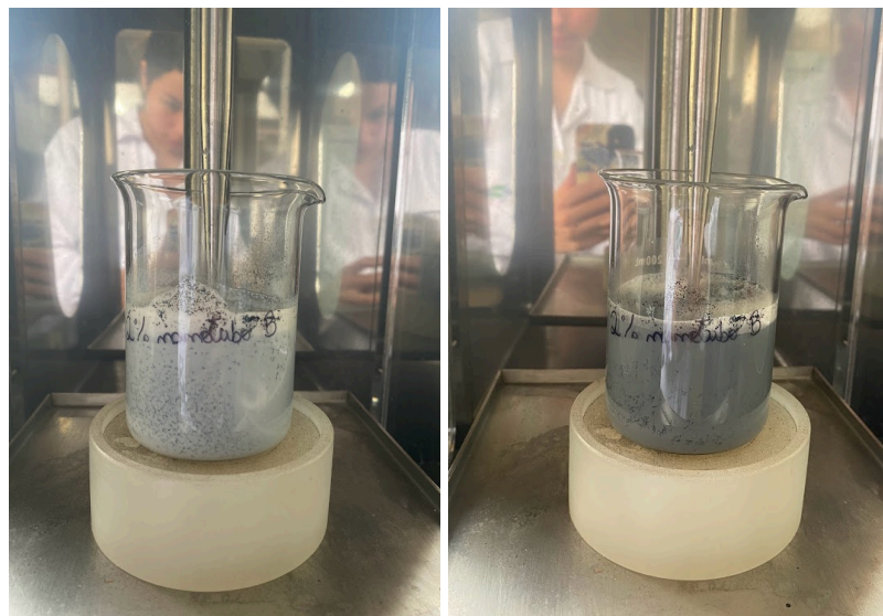
Figura 3.3 - (a) Amostra antes e (b) depois da sonicação.
