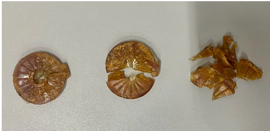
Figura 4.2 - Amostras de borracha natural com concentração de peróxido de 0,5%, 1,0% e 1,5%, respectivamente.
