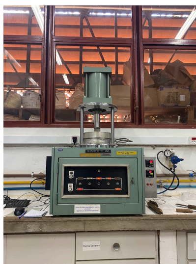
Figura 3.9 - Reômetro de disco oscilatório Monsanto.
