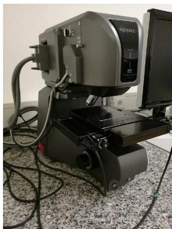
**Figura 15:** Fotografia do microscópio digital laser scanning (Keyence, modelo VK-9710).
