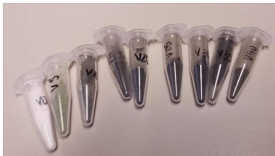
**Figura 7:** Pós prontos para a análise de ICP-OES armazenados e identificados.
