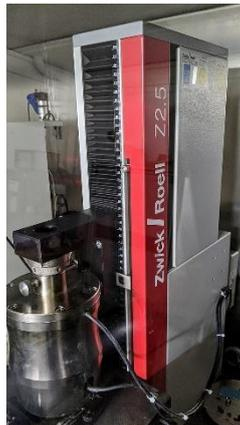
**Figura 14:** Foto do Equipamento Zwick/Roell 72.5 utilizado nos ensaios de Dureza Martens.
