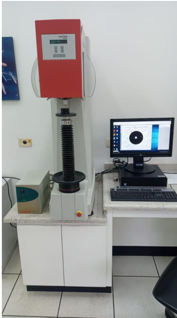
Figura 4.6: Durômetro automático da marca ZWICK / ROELL INDENTEC, acoplado a seu respectivo software instalado em terminal eletrônico para leitura dos valores de dureza.
