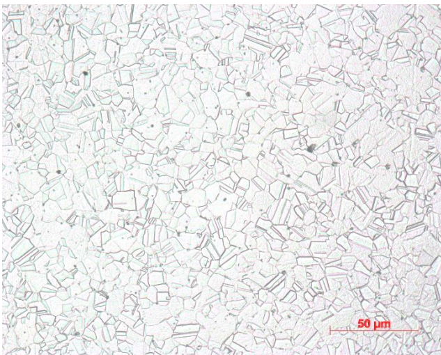
Figura 5.4: Microestrutura da liga VRC925® no estado bruto de laminação à quente. Aumento 500X
