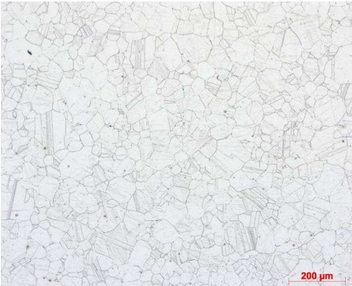
Figura 5.52: Microestrutura da liga VRC925® no estado envelhecido a 720°C por 24h. Aumento 100X
