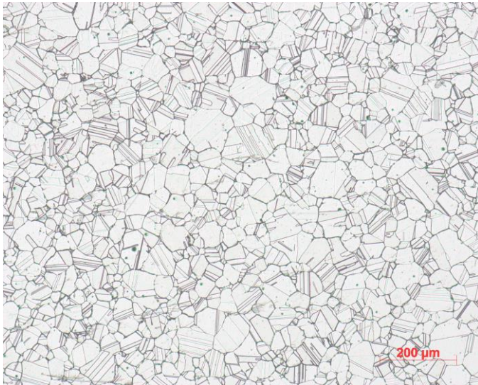
Figura 5.27: Microestrutura da liga VRC925® no estado envelhecido a 800°C por 8h. Aumento 100X
