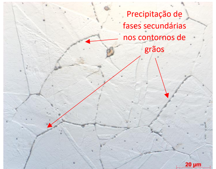
Figura 5.55: Microestrutura da liga VRC925® no estado envelhecido a 720°C por 24h. Aumento 1000X
