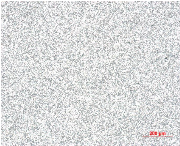
Figura 5.2: Microestrutura da liga VRC925® no estado bruto de laminação à quente. Aumento 100X
