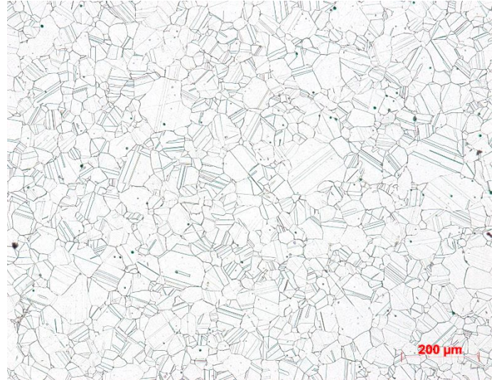
Figura 5.9: Microestrutura da liga VRC925® no estado envelhecido a 740°C por 8h. Aumento 100X
