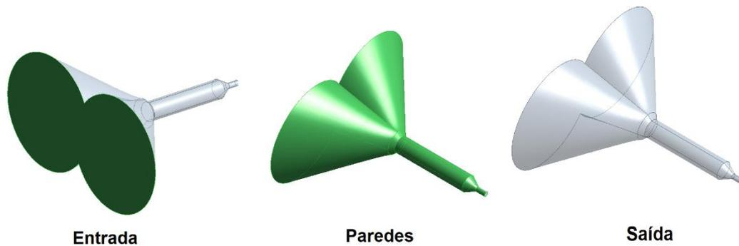
Figura 3.19 – Representação dos locais onde as condições de contorno são impostas nas análises CFD do escoamento no bico. Fonte: Elaborado pelo autor.
