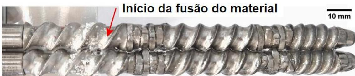
Figura 4.26 – Teste de extração da rosca dupla miniaturizada obtidas por Justino Netto (2022) para o PP RP141. Adaptado de [10].
