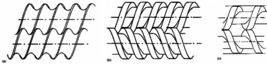
Figura 2.6 - a) Rosca dupla co-rotacional interpenetrante; b) Rosca dupla contra-rotacional interpenetrante; c) Rosca dupla contra-rotacional não interpenetrante. Adaptado de [47].
