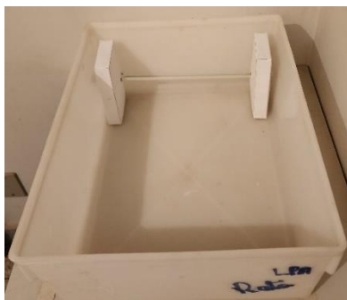
Figura 3. Fotografia da caixa experimental utilizada para o teste de catalepsia.
