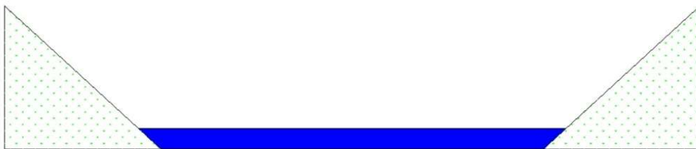
Figura 35. Nova seção proposta para o trecho C3 com a retificação do canal.
