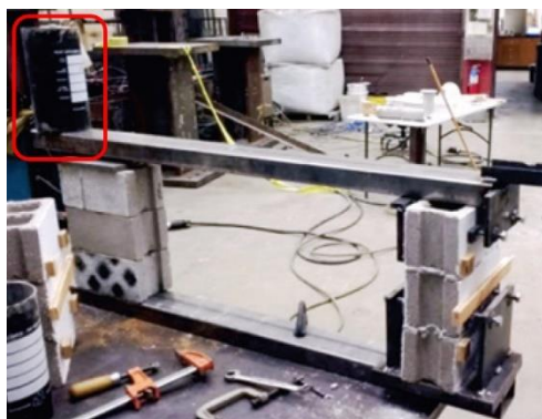
Figura 22 - Equipamento empregado e forma de ruptura do CP no ensaio de alavanca
