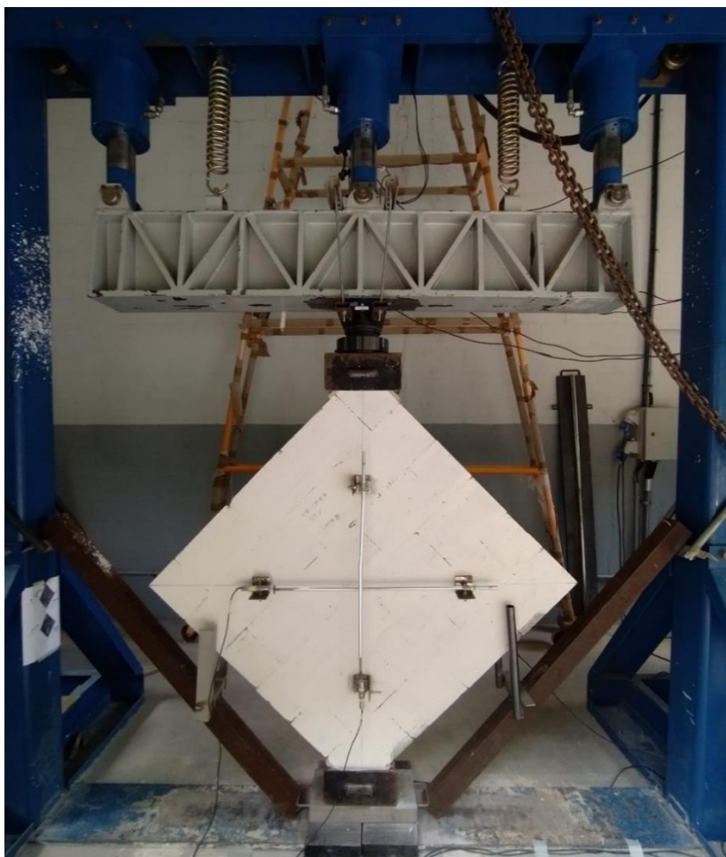
Figura 62 - Corpos de prova antes do ensaio de cisalhamento
