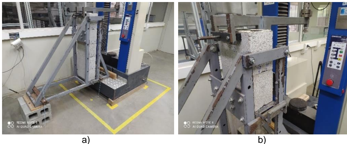
Figura 77 - Corpos de prova no ensaio de flexão da alavanca
