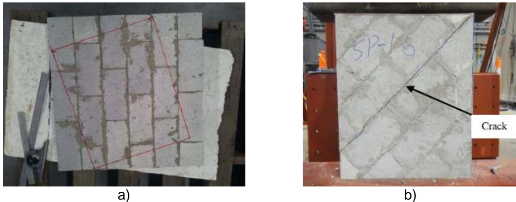
Figura 23 - Ensaio de compressão diagonal
