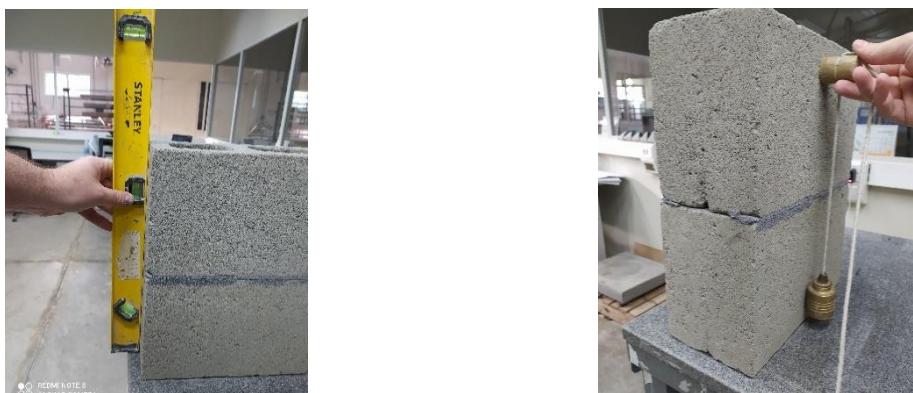
Figura 63 - Construção dos prismas
