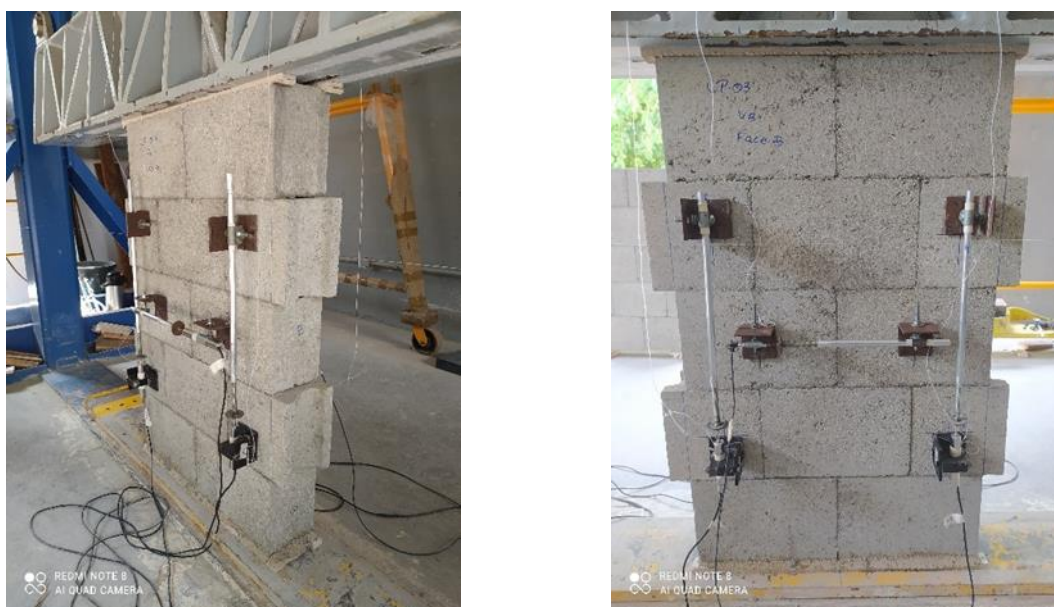
Figura 68 – Pequenas paredes utilizadas nos ensaios
