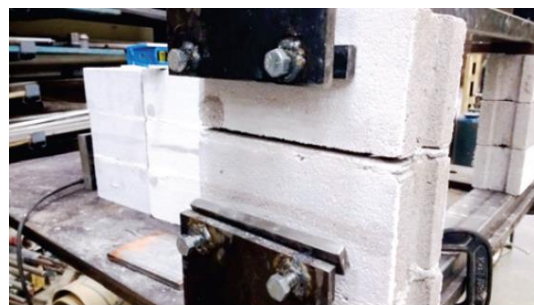
Figura 22 - Equipamento empregado e forma de ruptura do CP no ensaio de alavanca
