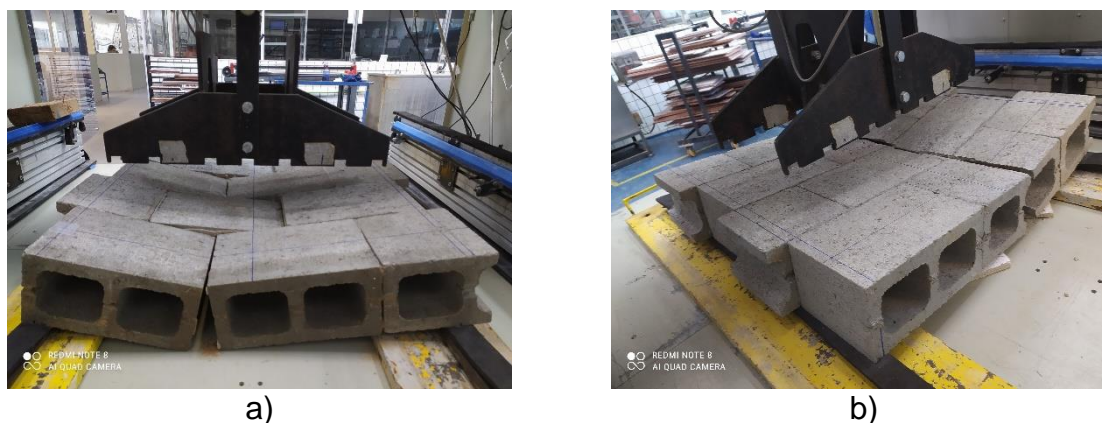
Figura 154 - Exemplos de rupturas observadas
