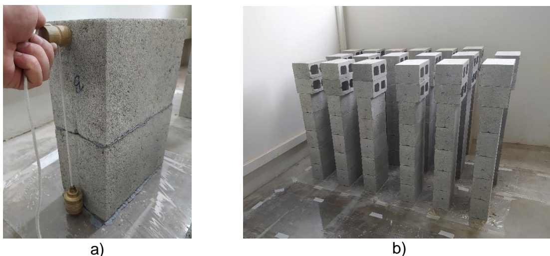
Figura 73 - Construção dos prismas para ensaio de flexão
