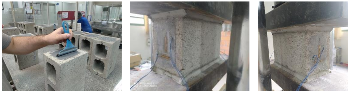
Figura 31 - Aplicação do compound adesivo
