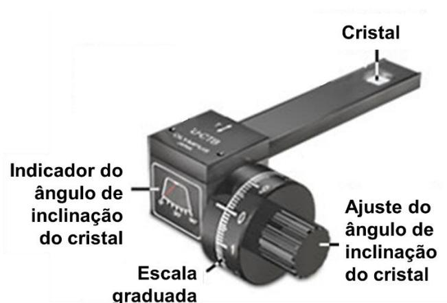
Figura 3.7 - Compensador de Berek. Adaptado de [70].
