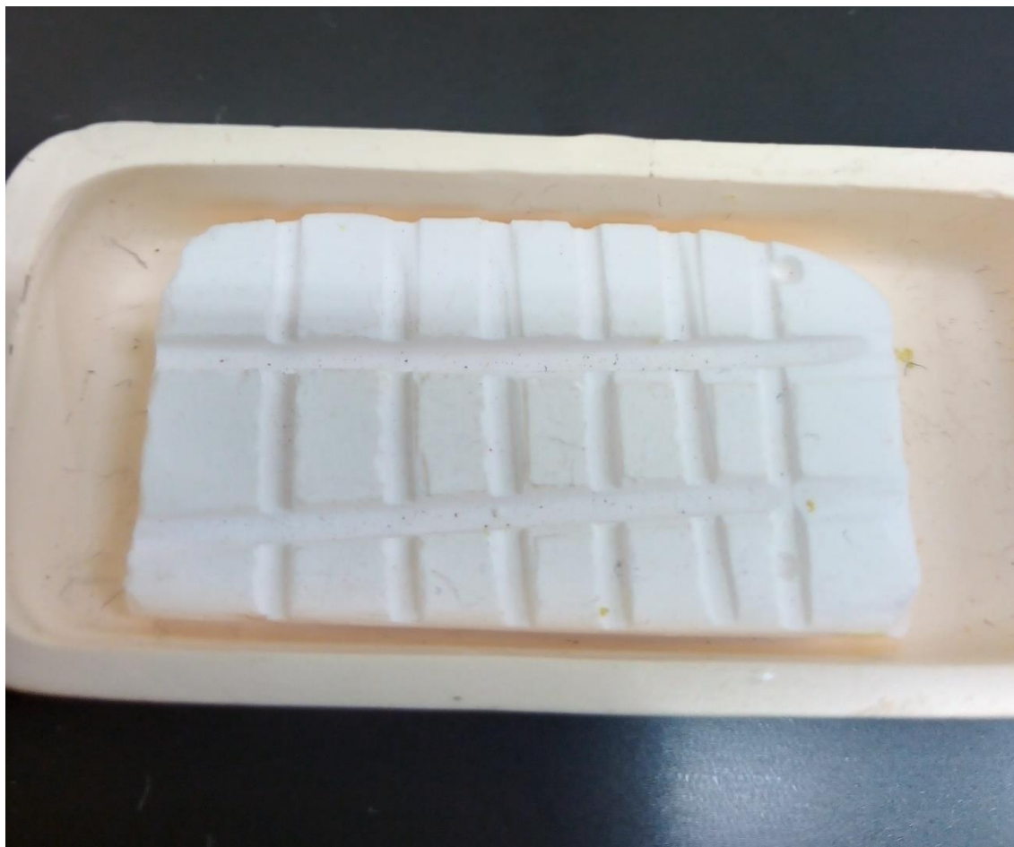
Figura 3.5 – Visão superior do porta amostras utilizado para cristalização das amostras, sendo uma barca de alumina-zirconia e uma placa de alumina pura chanfrada
