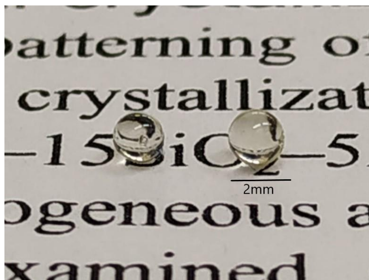
Figura 3.4 – Exemplos de duas amostras vítreas de BT5 obtidas pelo processo de levitação aerodinâmica
