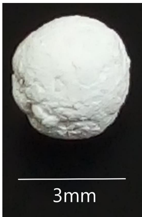
Figura 3.2 – Foto de uma esfera “a verde” moldada manualmente
