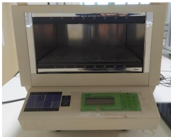
Figura 3.5 – Equipamento LaserComp modelo FOX 304 para análise de condutividade térmica [121].
