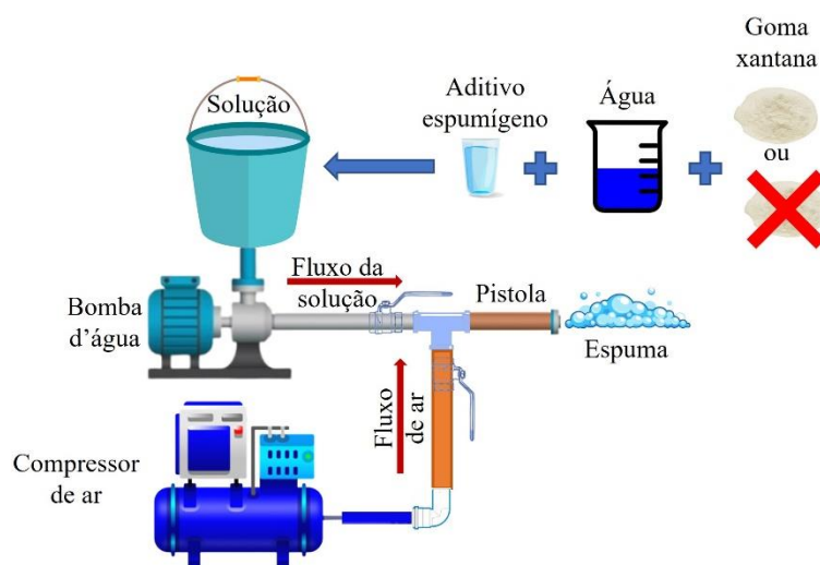
Figura 3.3 – Representação ilustrativa do sistema gerador de espuma utilizado neste trabalho.
