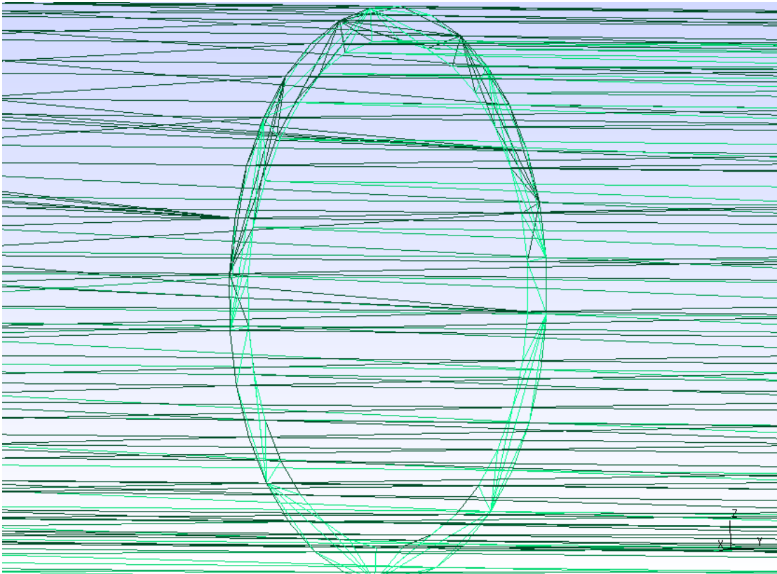
Figura 57 – A malha se encontrava com poucos nós e grandes espaços.
