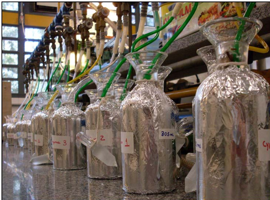
Figura 10. Aeração das câmaras através do borbulhamento com ar comprimido.
