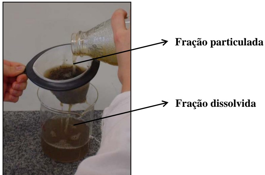
Figura 7. Separação do conteúdo das câmaras de decomposição em fração particulada e dissolvida.
