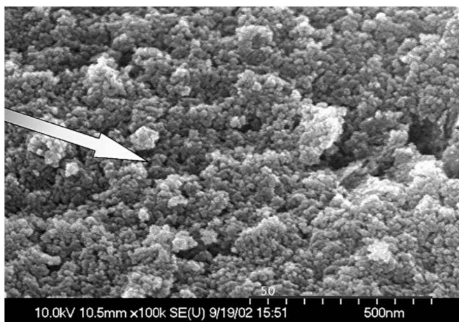
Figura 2.11 – Microestrutura de geopolímeros totalmente reagidos do tipo potássio-poli(sialato-siloxo) [189]. A seta evidencia as nanopartículas com dimensões variando de 5 a 15 nm separadas por nanoporosidade, cujas características estão na ordem de 3 a 10 nm.
