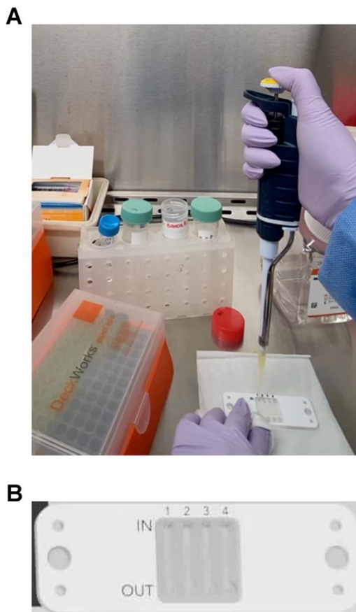
A – Preparo de amostras nas raias dos chips em ambiente controlado. B – Detalhe dos chips para dSTORM, com as raias indicando os locais de entrada (IN) e saída (OUT) dos líquidos. FONTE: Bianca C. Pachane (acervo pessoal) e ONI (oni.bio).
